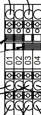
Пример соединения одной входящей пары с несколькими исходящими: 2 пары и 4 пары
