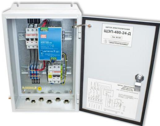
**Щиток электропитания ЩЭП-480-24-Д** (щиток) предназначен для организации электропитания устройств отображения времени на станциях метрополитена постоянным напряжением 24 В с максимальным выходным током не более 20 А и обеспечивает подключение до 3 нагрузок через пружинные клеммы типа Push-In с фронтальным подключением.
