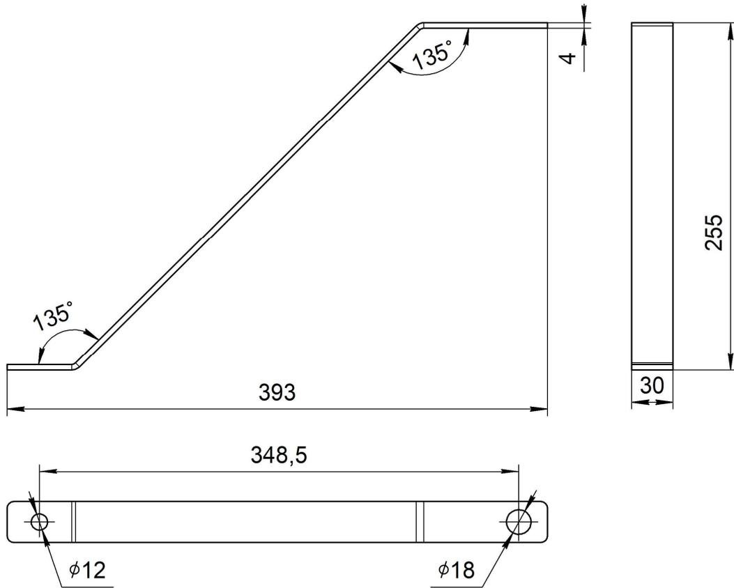
ОБЩИЙ ВИД, ГАБАРИТНЫЕ И УСТАНОВОЧНЫЕ РАЗМЕРЫ
