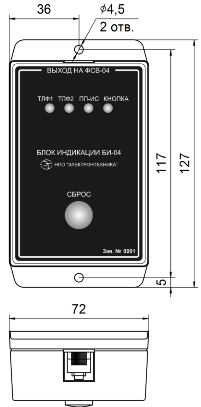
Рисунок 2 – Общий вид, габаритные размеры БИ-04
