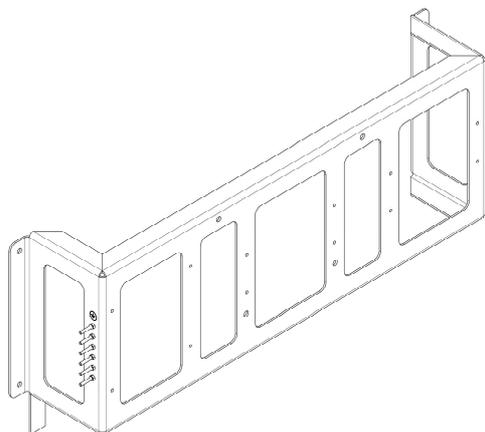
**Кронштейн АнСУ и УКСВ** (кронштейн) предназначен для крепления на стене антенного согласующего устройства, устройства контроля состояния волновода и прочего оборудования.
