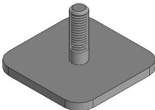
**Опора приварная** (опора) предназначена для установки кронштейнов волноводов в тоннелях из сборной железобетонной обделки с металлоизоляцией.
