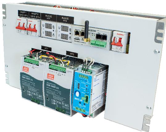
**Панель электропитания ПЭП2-480-24** (панель) предназначена для организации бесперебойного электропитания аппаратуры связи постоянным напряжением 24 В с максимальным выходным током 20 А при питании от двух фидеров переменного напряжения 220 В 50 Гц или от аккумуляторной батареи (АКБ) ёмкостью не менее 17 Ач.
